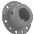
pbs42142 Messerträger mvUNI Knife holder mvUNI Welle Ø 25 mm, Messer Ø innen 42 mm / shaft Ø 25 mm, knife inner Ø 42 mm 6 Bohrungen und 6 Gewinde, passend für alle Rundmesser dieser Bauform / 6 holes and 6 threads, fits all circular knives of this type optional: geteilte Auflagescheiben zur Druckverteilung / optional: split support discs for even pressure
